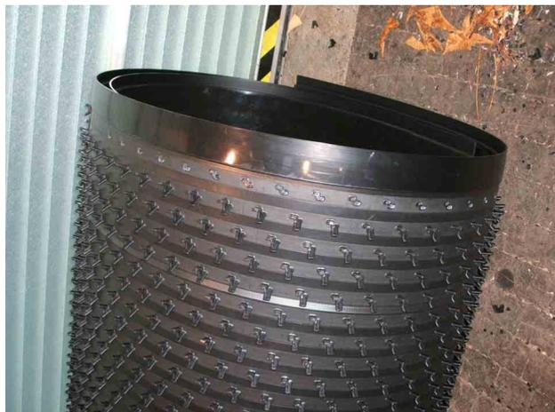
Die AGRU Sure Grip Betonschutzplatten wurden nach der Herstellung gemäß Kundenwunsch zu maßgeschneiderten Panels vorgefertigt. Dadurch wurde die Schweißarbeit im Tunnel verringert. Zusätzlich wurden elektrisch leitfähige Streifen an den zukünftigen Schweißstellen angebracht. Mittels dieser konnten nach der Verlegung sämtliche Schweißnähte (Funkenprüfung) auf Dichtheit getestet werden.
