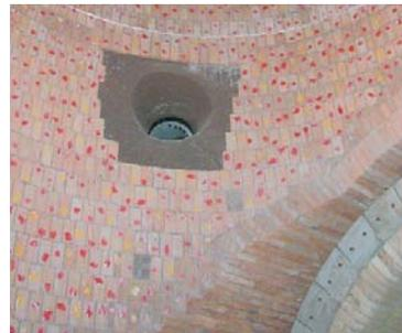
Blick in eine runde Nachbrennkammer mit ausgestampfter Brennermuffel.
