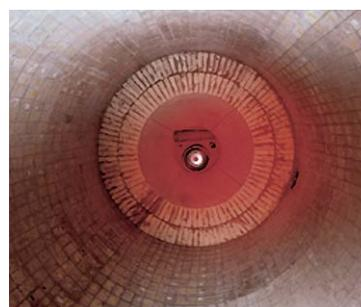
*Andalusitauskleidung eines Drehrohrofens zur Aktivkohleherstellung.*
