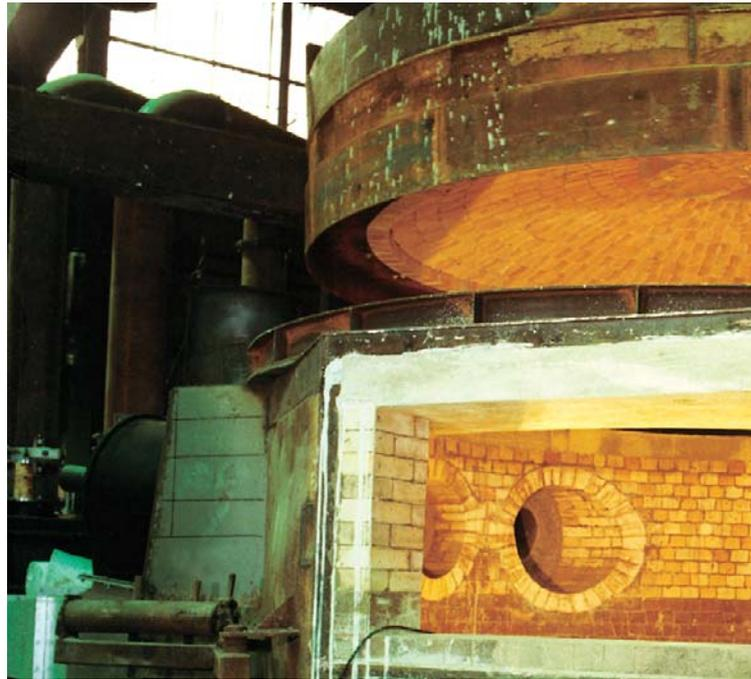
*Komplette feuerfeste Auskleidung in einem Aluminium-Rundschmelzofen.*
