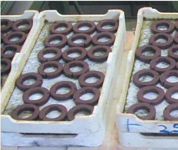
*Schubplatten und Sinterschalen zum Brand von Weichferriten in Durchschuböfen.*
