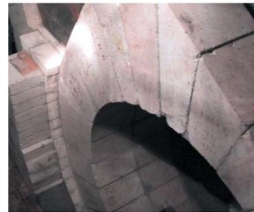
Großformatige Brennerformsteine in einem Reduktionsgaserhitzer.
