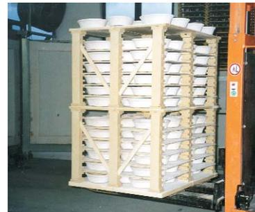
Der stabile Aufbau erlaubt die Staplerentnahme von kompletten Einheiten. Dadurch können auch größere Kammeröfen schnell gewechselt werden.
