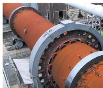
*Komplett ausgekleidete Drehrohröfen.*
