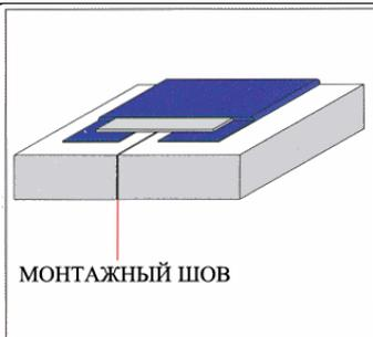
**Tricoflex**-клеевая система оптимально подходит для гидроизоляции монтажных швов в готовых строительных деталях и везде, где требуется последующая гидроизоляция швов.
