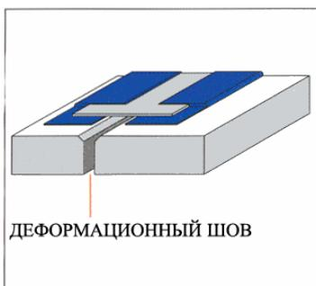
Деформационные швы могут быть надежно и без существенных издержек гидроизолированы **Tricoflex**-изолирующими лентами, 2 мм толщиной. Не приклеиваемая область растяжения у **Tricoflex**-клеевой системы обеспечивает компенсацию деформаций строительных деталей без нарушения их плотности.
